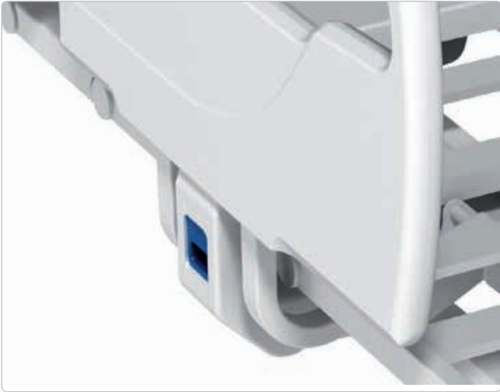
Centuris Pro lovos su atskiromis šoninėmis apsaugomis šoninės apsaugos turi savaiminio nuleidimo mechanizmą, kuris aktyvuojamas vienos rankos judesiu, greitai ir tolygiai nuleidžia šoninės apsaugas žemyn. Šoninių apsaugų porankiai dėl galimybės patogiai įsikibti palengvina ligonio pasivertimą lovoje ar išlipimą iš jos.
